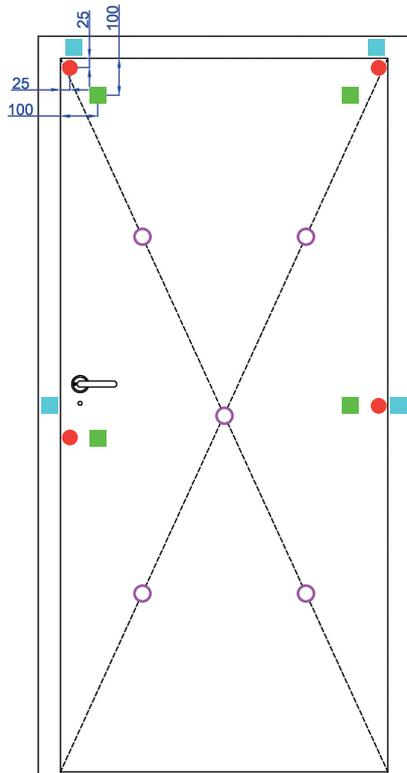
L'isolation thermique (I), autrefois appelée « coupe-feu » dans les normes françaises, est un critère qui mesure la montée en température de la porte du côté protégé.
